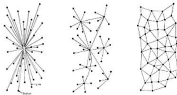
Red centralizada, descentralizada, distribuida
